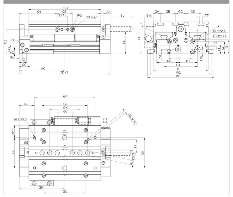
t = Tiefe\* CKP 16: 2x Schmieröffnungen auf jedem Laufblock, CKP 25 / 30: Schmiernippel in Trichterform mit Gewindeanschluss M3
