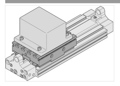
Befestigung des Automationssystems Easy2Combine an CKP über Zentrierringe und Nutensteine
