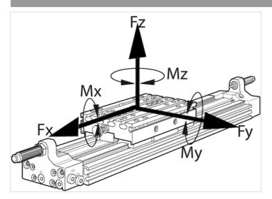
Bei gleichzeitig auf den Zylinder wirkenden Momenten muss diese Formel zusätzlich zur Prüfung des maximalen Moments angewendet werden. In der Dämpfungsphase der Bewegung treten zusätzliche Kräfte auf, die zu berücksichtigen sind. Bitte verwenden Sie das Berechnungsprogramm für kolbenstangenlose Zylinder unter http://www.aventics.com.
