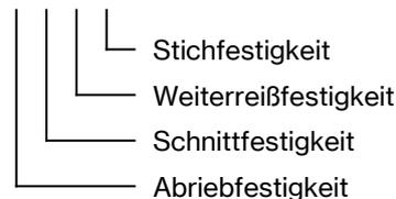
Piktogramm und Leistungsstufen nach EN 388 : 2003 (höchste Leistungsstufe: 4, bei Schnitffestigkeit: 5)
