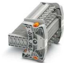
Teststecker, Nennspannung: 400 V, Nennstrom: 24 A, Anschlussart: Schraubanschluss, Bemessungsquerschnitt: 2,5 mm<sup>2</sup>, Farbe: grau
