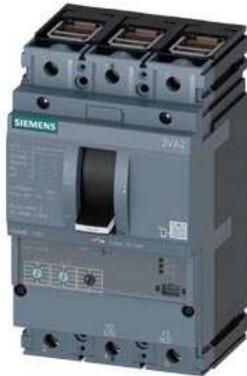
Leistungsschalter 3VA2 IEC Frame 160 Schaltvermögenklasse C Icu=110kA @ 415V 3-polig, Anlagenschutz ETU320, LI, In=160A Überlastschutz Ir=63A...160A Kurzschlusschutz Ii=1,5...10 x In Klemmenanschluss
