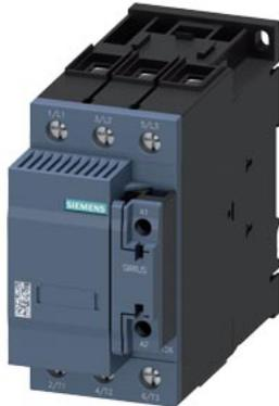
Kondensatorschütz, AC-6b 75 kVA<sub>r</sub>, / 400 V 2 Ö, AC 50-60 Hz / DC 175-280 V 3-polig, Baugröße S2 Schraubanschluss
