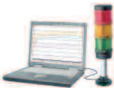
Commande directe de l'élément de signalisation par la prise USB
