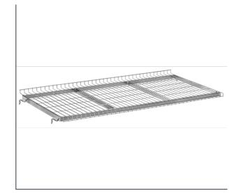
Etagenboden aus Drahtgitter 120 x 30 mm, galvanisch glanzverzinkt. An einer Längsseite 23 mm nach oben, an der anderen 23 mm unten abgekantet. Im Raster von 100 mm waagerecht oder geneigt einhängbar. Tragkraft pro Boden 40 kg
