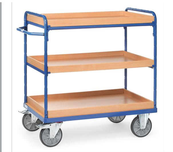
Baukasten-System: Aus Stahlrohr und Profilstahl geschweißt, pulverbeschichtet blau RAL 5007, Schraubkonstruktion. Stirnwände offen. 1 fester und 2 Einlegekästen aus Holzwerkstoffplatten, Oberfläche Buchendekor. Einlegekästen variabel einsetzbar, Teilung 100 mm. Tragkraft pro Einlegekasten 120 kg. 2 Lenk- und 2 Bockrollen, TPE-Bereifung, Naben mit Rillenkugellager. Feststeller an den Lenkrollen, gemäß der Europäischen Norm EN 1757-3 (Sicherheit von Plattformwagen).
