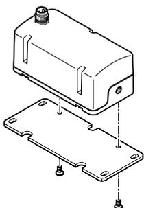
Das VEMD Ventil wird auf der Wandbefestigung VAME-P14-W mit zwei Schrauben befestigt.
