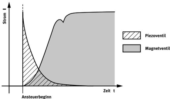
Im Vergleich zum Magnetventil brauchen Proportionalventile mit Piezotechnologie durch ihren kapazitiven Charakter so gut wie keine Energie zur Wahrung eines aktiven Zustandes. Das Piezoventil arbeitet ähnlich wie ein Kondensator: Zum Aufladen der Keramik benötigt es nur am Anfang Strom.
