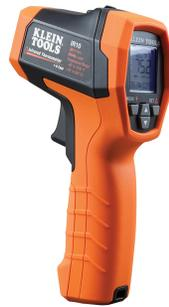
Das Klein Tools IR10 ist ein professionelles Infrarot-Thermometer (IR) mit Laser-Leitstrahl. Es verfügt über einen großen Messbereich, eine hohe optische Auflösung von 20:1, zwei Ziellaser und verschiedene Berechnungsmodi für verschiedene Temperatur-Messanwendungen. Es misst die Temperatur sowohl anhand der IR-Emissionen als auch anhand eines Standard-Messfühlers vom Typ K.
