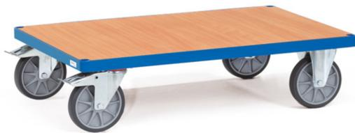
Profilstahl geschweißt, pulverbeschichtet RAL 5007, Plattform Holzwerkstoffplatte, Oberfläche Buchendekor. 2 Lenk- und 2 Bockrollen, TPE-Bereifung, Naben mit Rillenkugellager. Feststeller an den Lenkrollen, gemäß der Europäischen Norm EN 1757-3 (Sicherheit von Plattformwagen).
