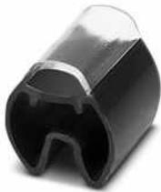
Ader-Bezeichnungsträger, transparent/schwarz, unbeschriftet, Montageart: aufschieben, Kabeldurchmesserbereich: 4 ... 7 mm, Schriftfeldgröße: 10 x 4 mm
