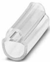
Ader-Bezeichnungsträger, transparent, unbeschriftet, Montageart: aufschieben, Kabeldurchmesserbereich: 0,6 ... 1,2 mm, Schriftfeldgröße: 10 x 4 mm
