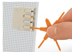
Kodieren einer THT-Stiftleiste durch Einschieben eines Kodierstiftes
