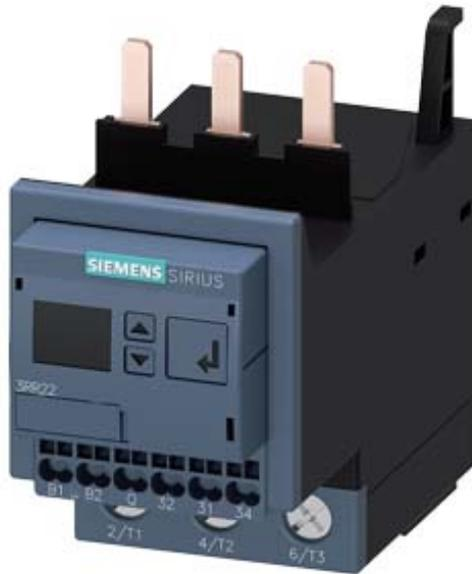
Überwachungsrelais, anbaubar an Schütz 3RT2, Baugröße S2 Standard, digital einstellbar Schein-/Wirkstromüberwachung 8...80 A, 20...400 Hz, 3-phasig Versorgung 24 V AC/DC 1 Wechsler, 1 Halbleiterausgang für Alarm und Warnung Überwachung auf Stromüber- und Unterschreitung Phasenausfall, Drahtbruch Phasenfolge Fehlerstrom Blockierstrom Warnung und Alarmschwellen mit oder ohne Fehlerspeicher Anlaufverzögerung 0-99 s Störspitzenausblendung 0-30 s Pause nach Fehler 0-300 min Federzugtechnik
