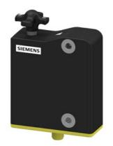
RFID-Sicherheitsschalter mit Zuhaltung, Kunststoff, Arbeitsstromprinzip, Betätiger- Überwachung, 24V DC, mit Hilfsentriegelung, IP69, Zuhaltekraft 1150 N, individuell codiert mehrfach anlernbar, Codierstufe hoch nach ISO 14119, Diagnoseausgang, M12 Stecker 8-polig, 3 LEDs zur Anzeige der Betriebszustände, 3 Betätigungsrichtungen, Rastkraft mit Drehkreuz verstellbar: 25 N oder 50 N. Hygienegerechtes Design. Betätiger 3SE6410-1AC01 separat bestellen.
