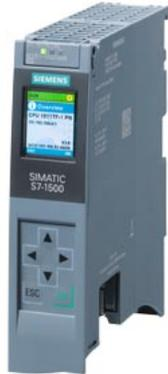
SIMATIC S7-1500T, CPU 1511TF-1 PN, Zentralbaugruppe mit Arbeitsspeicher 450 KB für Programm und 1,5 MB für Daten, 1. Schnittstelle: PROFINET IRT mit 2 Port Switch, 25 ns Bit-Performance, SIMATIC Memory Card notwendig \* \*\*\*\*
