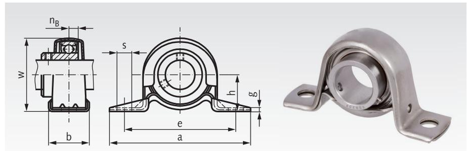
Bestellangaben: z.B.: Art.-Nr. 625 992 12, Kugel-Stehlager SSBPP 201, Bohrung 12mm
