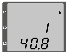
Abb. Messwertanzeige Betriebsstundenzähler
