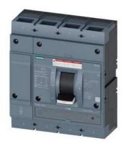
Leistungsschalter 3VA5 UL Frame 800 Schaltvermögenklasse H 65kA @ 480 V 4-polig, Anlagenschutz TM230, FTAM, In=700A Überlastschutz Ir=700A fest eingestellt Kurzschlussschutz Ii=5...10 x In N-Leiter 1 Schraubenflachanschluss
