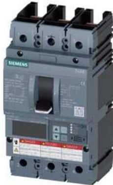
Leistungsschalter 3VA6 UL Frame 150 Schaltvermögenklasse M 35kA @ 480V 3-polig, Anlagenschutz ETU830, LIG, In=40A Überlastschutz, 100% rated Ir=16A...40A Kurzschlusschutz li=1,5...12 x In Erdschlusschutz Ig=0,375...1 x In, tg=0,05-0,8s ohne Anschluss
