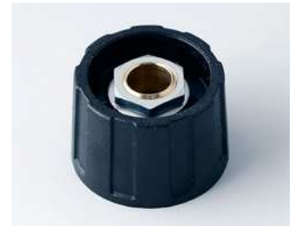
A2523630 RUNDKNOPF 23, ohne Strich ABS (UL 94 HB) schwarz RAL 9005 23x15mm 1/4"
