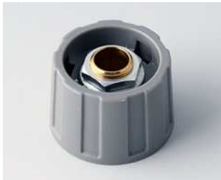
A2523638 RUNDKNOPF 23, ohne Strich ABS (UL 94 HB) staubgrau RAL 7037 23x15mm 1/4"
