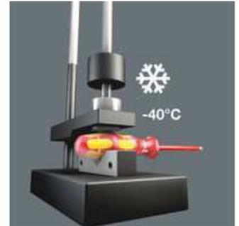
Auch bei extremen Einsatzbedingungen ist durch die geprüfte Kaltschlagfestigkeit bei  $-40\text{ }^{\circ}\text{C}$  die Sicherheit gewährleistet.
