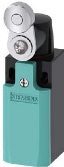
Positionsschalter Kunststoff 31 mm nach DIN EN 50047 erhöhter Korrosionsschutz Geräteanschluss 1 x (M20 x 1,5) 1S/1Ö Sprungkontakte Schwenkantrieb rechts/links einstellbar, mit Edelstahlhebel und Kunststoffrolle 19 mm funktionsfähig bei -40 °C Schock- und Schwingprüfung nach DIN EN 61373, Kategorie 1B
