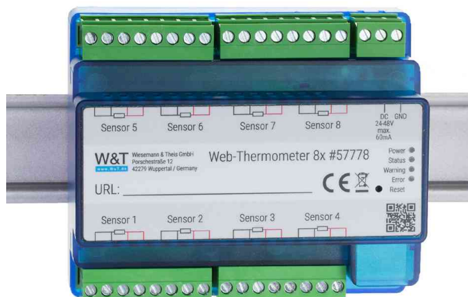
Symbolbild: Web-Thermograph 8-fach (Lieferung ohne Schiene)
