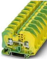
Schutzleiterklemme mit Bolzenanschlusstechnik, Querschnitt: 0,1 - 6 mm<sup>2</sup>, AWG: 26 - 10, Breite 16,3 mm, Farbe: grün-gelb
