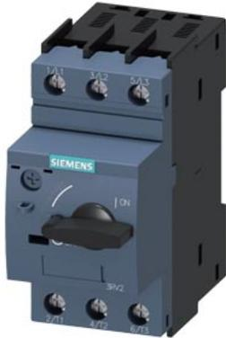
Leistungsschalter Baugröße S0 für den Trafoschutz A-Auslöser 1,4...2 A N-Auslöser 42 A Schraubanschluss Standardschaltvermögen
