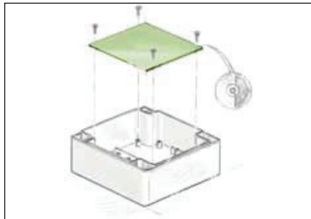
Abgesetzte Nocken zum Einklemmen von rechteckigen Leiterkarten oder Montageplatten (nicht im Lieferprogramm enthalten).
