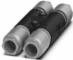
H-Verteiler, QUICKON-Anschluss, 1 mm<sup>2</sup> ... 2,5 mm<sup>2</sup>, 690 V, 20 A, grau, mit vier QUICKON-Muttern, Leitungsaußendurchmesser: 6 mm ... 10 mm
