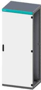
SIVACON, Schaltschrank- Leergehäuse, ohne Seitenwände, nach IEC 62208, IP55, H: 1800 mm, B: 400 mm, T: 1000 mm
