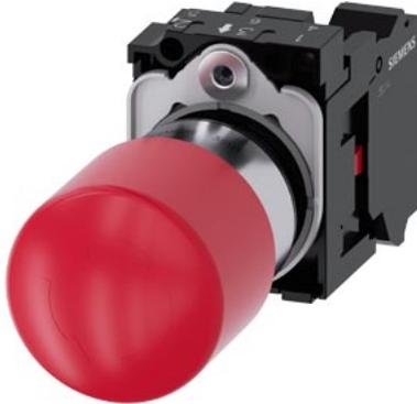
NOT-HALT-Pilzdrucktaster, 22 mm, rund, Metall, hochglanz, rot, 30 mm, zwangsläufige Verrastung, gemäß DIN EN ISO 13850, Drehentriegelung, Unterlegscheibe für NOT-HALT, gelb, ohne Beschriftung, mit Halter, 1Ö, Federzuganschluss, Frontplattenbefestigung
