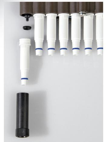
Mit einem speziellen, mitgelieferten Schlüssel lassen sich einzelne Schäfte mit Dichtungen einfach herausdrehen. Schaft und Dichtung können jetzt leicht gereinigt oder ausgetauscht werden. Durch dieses patentierte Verfahren entfallen teure Reparaturen und lange Ausfallzeiten.
