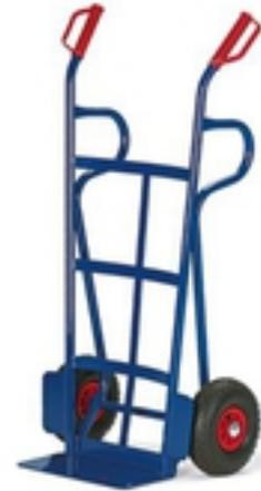
Stahlrohr (a'Ëœ 26,9 x 1,75 mm). Schaufel aus Stahlblech (t= 4 mm). Räder mit Kunststofffelge und Rollenlager. In die Rückwand der Sackkarren sind waagerechte Flacheisen eingeschweißt, die jeweils nach hinten gewölbt sind. Pulverbeschichtung in Enzianblau (RAL 5010). Schaufelbreite: 400 mm
