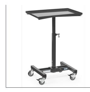
Construction en profilé et tube d'acier avec plateau en tôle d'acier et rebord de 20 mm sur les 4 côtés, revêtement époxy gris anthracite RAL 7016. Pour bacs en plastiques, corbeilles en treillis etc. Hauteur règlable au pas de 25 mm. Non inclinable. Blocage assuré par doigt d'indexage. 4 roues pivotantes à bandage TPE, moyeu à palier lisse. 2 roues avec freins.
