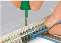
Leiter anschließen/lösen – Serie 256.
