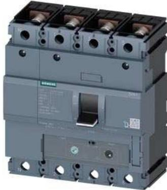
Leistungsschalter 3VA1 IEC Frame 250 Schaltvermögenklasse M Icu=55kA @ 415V 4-polig, Anlagenschutz TM240, ATAM, In=160A Überlastschutz Ir=112A...160A Kurzschlusschutz Ii=5...10 x In N-Leiterschutz 100% Schraubenflanschanschluss
