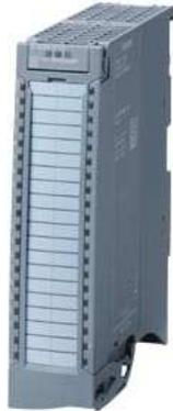
SIMATIC S7-1500, Digitaleingabemodul DI 16x24VDC HS; 16 Kanäle in Gruppen zu 8; für 24V-Geber; Sensorversorgung 24VDC; Eingangstyp 2 (IEC 61131); Eingangsverzögerung parametrierbar 0,05..20ms; taktynchr. Betrieb bis 250µs; integr. Zählfunktion bis 20kHz; Impulsverlängerung; Flatter-überwachung; Signalinvertierung Diagnose; Prozessalarml: Frontstecker (Schraubklemmen oder Push-In) und ggf. Schirmset separat bestellen
