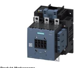
Leistungsschütz, AC-3 115 A, 55 kW / 400 V AC (50-60 Hz) / DC-Betätigung AC/DC 200-277 V Hilfskontakte 2 NO + 2 NC 3-polig, Baugröße S6 Schienenanschlüsse Antrieb: elektronisch mit SPS-Schnittstelle DC 24 V Federzuganschluss
