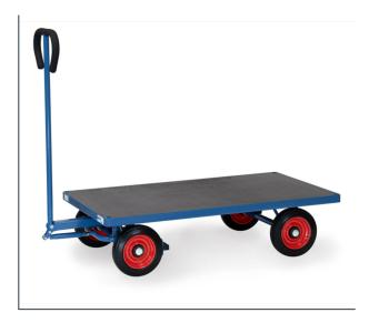
Aus Profilstahl und Stahlrohr geschweißt, pulverbeschichtet blau RAL 5007. Ladefläche aus wasserfestem Sperrholz. Drehschemel-Lenkung mit Deichsel und Handgriff. Räder mit Vollgummibereifung, Naben mit Rollenlager. Deichsel mit Sicherheitshandgriff mit Softgripbezug und automatischer gedämpfter Rückstellung in Ruheposition. Automatische Feststellbremse auf die Vorderräder wirkend, entspricht der Europäischen Norm EN 1757-3.
