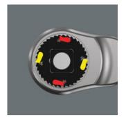
Durch die Doppelklinkenkonstruktion wird aus 38 robusten Zähnen eine 76er Feinzahn-Teilung erreicht. Diese 76er Teilung führt zu einem sehr geringen Rückholwinkel von 4,7°.
