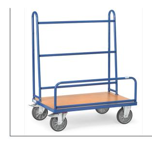
Stahlrohr- und Profilstahl geschweißt, pulverbeschichtet blau RAL 5007. Plattform Holzwerkstoffplatten, Oberfläche Buchendekor. Aufbau Stahlrohr-Konstruktion verschraubt. 2 Lenk- und 2 Bockrollen, TPE-Bereifung, 200 x 40 mm, Naben mit Rillenkugellager. Feststeller an den Lenkrollen gemäß der Europäischen Norm EN 1757-3 (Sicherheit von Plattformwagen). Anlagehöhe: 1050 mm, Haltebügelhöhe: 300 mm.
