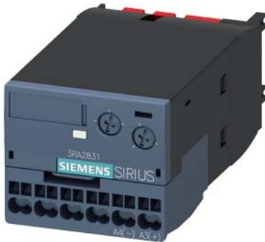
Elektronisches Zeitrelais, ansprechverzögert, mit Halbleiterausgang, Zeitbereich 0,05-100 s, AC/DC 24-90 V, 50/60 Hz, Varistor zur Bedämpfung der Schützspulen integriert, Federzuganschluss, frontseitig aufsnappbar auf Schütze 3RT2.3 / 3RT2.4
