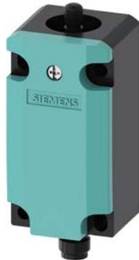
Basisschalter für Positionsschalter 3SE51 Metallgehäuse 40 mm nach DIN EN 50041 1S/1Ö Schleikontakte mit M12-Stecker, 5-polig, feste PIN-Belegung: PIN1=21, PIN2=22 PIN3=13, PIN4=14, PIN5=PE ohne Antriebskopf
