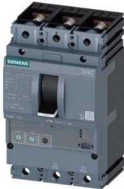
Leistungsschalter 3VA2 IEC Frame 160 Schaltvermögenklasse E Icu=200 kA @ 415 V 3-polig, Anlagenschutz ETU320, LI, In=160A Überlastschutz Ir=63A ... 160A Kurzschlusschutz Ii=1,5...12 x In Schraubenflächanschluss
