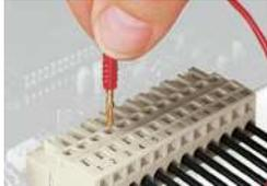
Prüfen – Federleiste mit CAGE CLAMP® Steckbarer Prüfabgriff, rechtwinklig zur Leiteranschlussrichtung, mit Prüfstecker Ø 2 mm und Ø 2,3 mm
