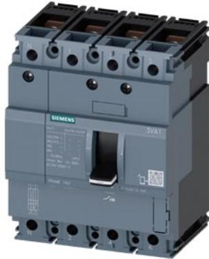
Leistungsschalter 3VA1 IEC Frame 160 Schaltvermögenklasse S Icu=36kA @ 415V 4-polig, Anlagenschutz TM210, FTFM, In=20A Überlastschutz Ir=20A fest eingestellt Kurzschlusschutz Ii=16 x In N-Leiter ungeschützt Schraubenflachanschluss
