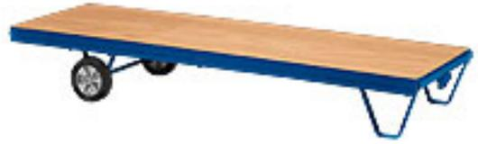
Ladefläche: L 2000 x B 1000 mm Au ssenma ss: L 2010 x B 1000 mm 1000 kg Tragkraft - Rad-ø 200 mm Radmaterial: Vollgummi-Elastik
