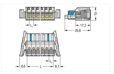
Abmessungen in mm L = (Polzahl x Rastermaß) + 1,5 mm L1 = 5 mm 2-polige Federleisten – nur 1 Rastnase
