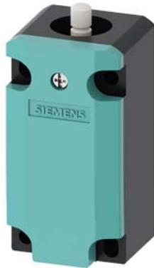
Basisschalter für Positionsschalter 3SE5132 Gehäuse Kunststoff nach EN 50041, 1 x (M20 x 1,5) 1S/2Ö Schleichkontakte ohne Antriebskopf
