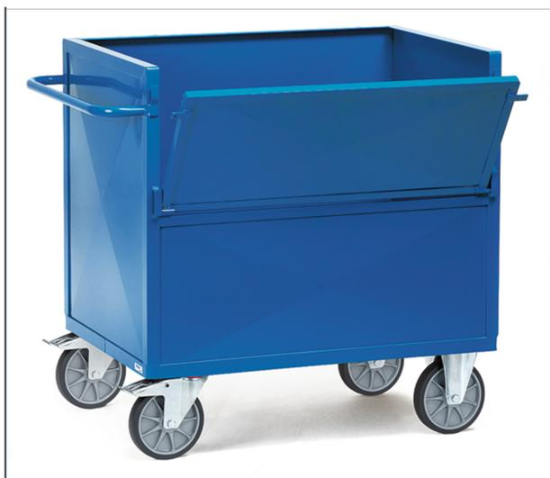
Ensemble mécano-soudé, revêtement époxy bleu RAL 5007. Chariot entièrement en tôle d'acier. 2 roues pivotantes et 2 roues fixes à bandage TPE, moyeu à roulement à billes central. Freins sur roues pivotantes conformément à la Norme Européenne EN 1757-3 (Sécurité des chariots de manutention).
