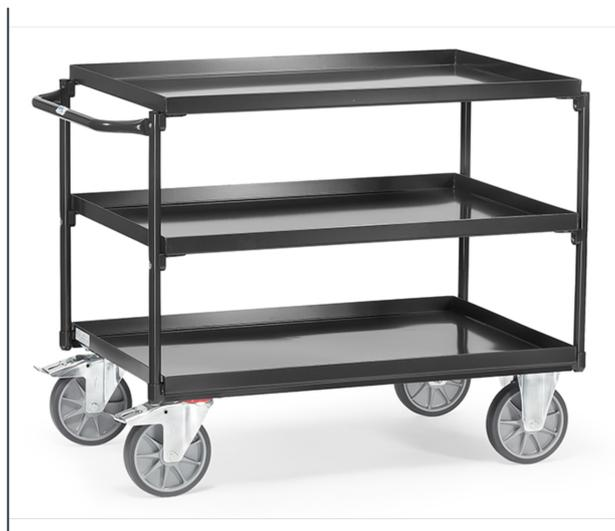
Construction en acier avec 3 plateaux étanches et rebord de 40 mm, revêtement époxy gris anthracite RAL 7016, dossier de poussée horizontal. Charge maximum plateau du haut et médian : 200 kg. 2 roues pivotantes et 2 roues fixes à bandage TPE, moyeu à roulement à billes central. Freins sur roues pivotantes conformément à la Norme 1757-3 (Sécurité des chariots de manutention).
